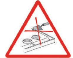
Le contact direct de plâtre ou de colle pour plaques ou carreaux de plâtre avec la sous-face du receveur est à proscrire. Il ne doit pas avoir de blocage vertical ni latéral du receveur.
